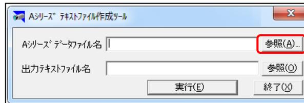
②「Aシリーズ データファイル名」の右横の「参照」ボタンをクリックすると、下図のウィンドウが開きます。ここで変換元となるcpmファイルを選択します。
