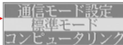
Aシリーズの「通信モード設定」に、[標準モード]/[コンピュータリンク]のどちらが設定されているかご確認ください。
